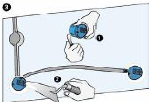
Ouvrez les opercules des boîtiers nécessaires au passage des conduits(1), puis scellez les boîtiers au plâtre (2).
