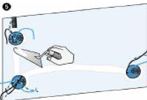
Rebouchez les saignées au plâtre. Vous pouvez maintenir les conduits au fond des saignées grâce à de petits clous ou des chutes de fils de cuivres posés en travers.
