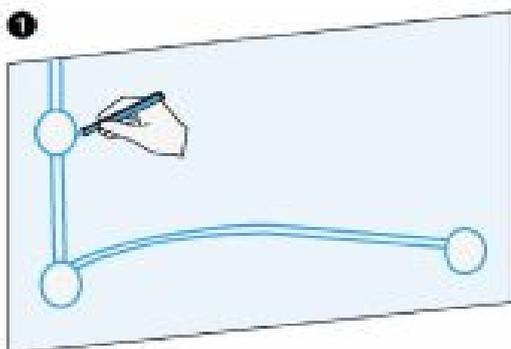
Tracez sur le mur l'emplacement des boîtiers pour l'appareillage et les saignées pour le passage des conduits.
