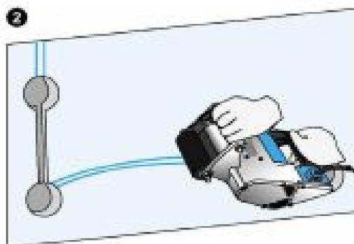
Réalisez les trous des boîtiers à la scie cloche (diam. 67-68mm), montée sur un perforateur. Ensuite, effectuez les saignées de préférence à la machine.
