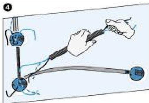
Prenez la mesure des conduits en les présentant dans les saignées. Passez les conducteurs et remplacez les conduits ainsi équipés.
